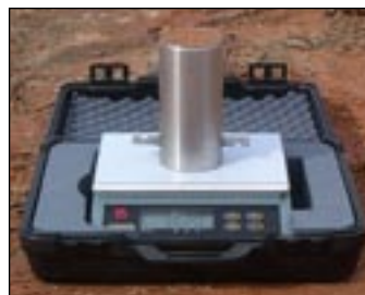
Fig 3: Determinar la densidad en húmedo de la muestra de suelo del molde.
