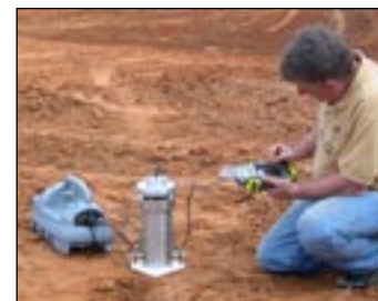
Fig 4: Tomar una medida de TDR en la muestra de suelo del molde.
