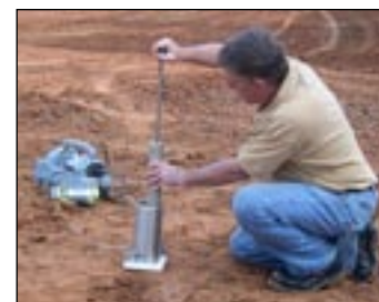
Fig 2: Tomar una muestra de suelo in situ y apisonarla en el molde de campo.
