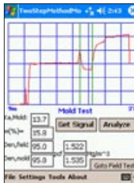
Fig 3: Determinar la densidad en húmedo de la muestra de suelo del molde.
